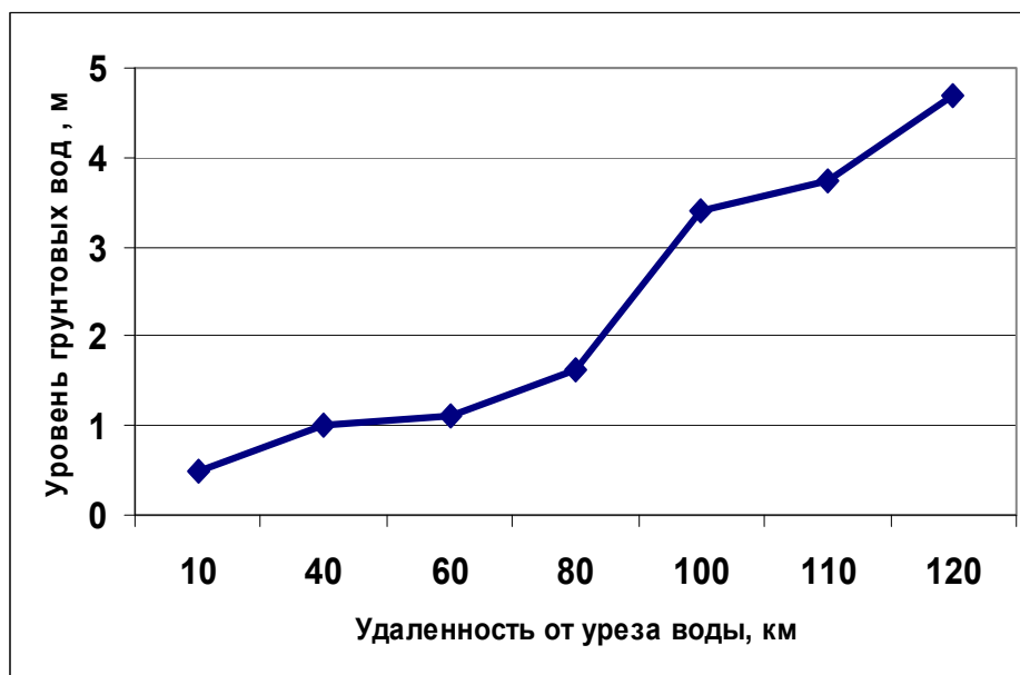
Рис 4.3. Зависимость уровня грунтовых вод от удаленности от уреза воды
